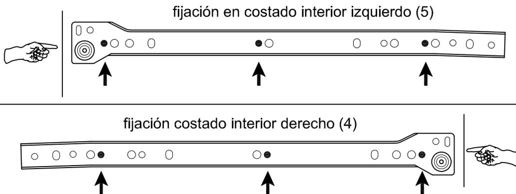
**PRECAUCION:** Las correderas metálicas no son iguales, son izquierda y derecha dependiendo del costado. Guíese de estos dibujos para su instalación (las ruedas siempre van hacia abajo).
