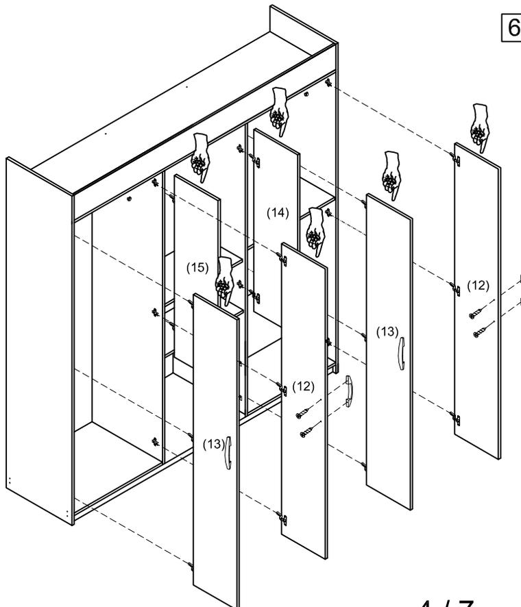
6 Enderece el mueble e instale las puertas, como lo muestra la figura. Para esto, coloque las bisagras sobre sus respectivas bases.....aprete el tornillo 1 para fijar la puerta.
