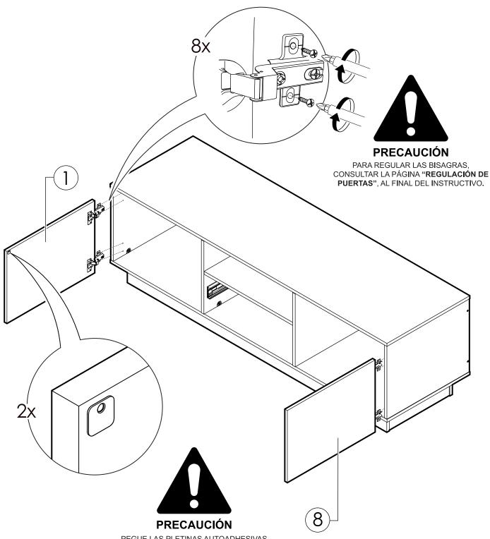
PEGUE LAS PLETINAS AUTOADHESIVAS EN LAS PUERTAS. PARA ESTO, CIÉRRELAS PRIMERAMENTE PARA DEFINIR LA POSICIÓN CORRECTA DE LAS PLETINAS, ÉSTAS DEBEN QUEDAR SOBRE EL PISTÓN MAGNÉTICO DEL RETÉN.
