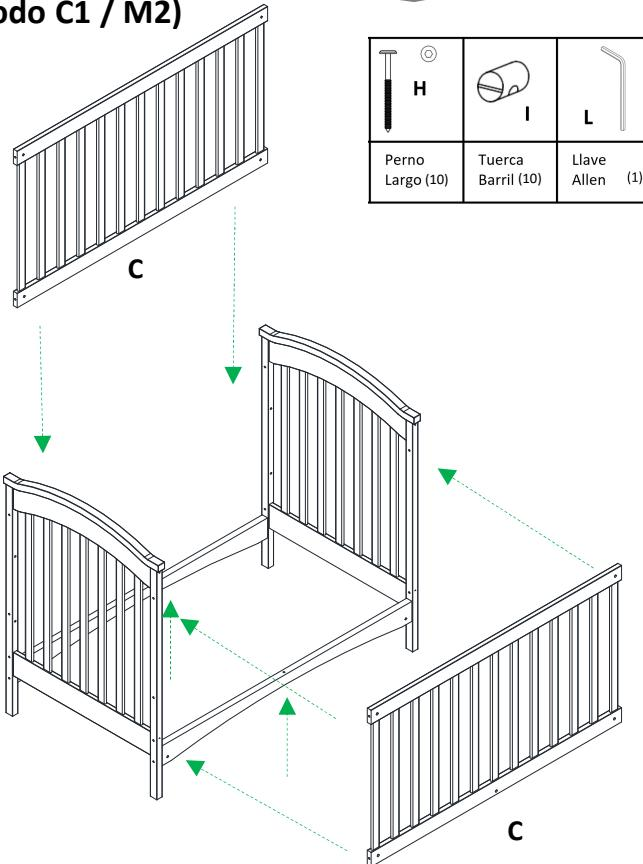
**(Modo C1 / M2)** Coloque las 10 tuercas barril (I) en las barandas (C), según muestra el detalle. Coloque las 2 barandas largas (C) entre ambas cabeceras (A), con la precaución de que las 10 tuercas barril deben quedar mirando hacia adentro. Coloque 8 pernos largos (H) desde las cabeceras hacia las barandas, y 2 pernos desde los largueros hacia las barandas. Con la llave allen (L) atornille estos pernos en las tuercas barril.
