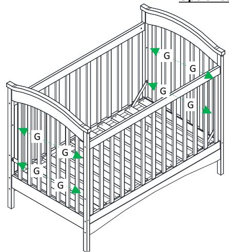
**(Modo C1)** Coloque 8 pernos cortos (G) restantes en las patas de las cabeceras (A), según muestra el detalle. Estos 8 pernos se fijan en dos niveles: 4 en la parte baja y 4 en la parte central. Esto es para colocar el somier en 2 posiciones. Coloque el somier (B) en la parte baja de la cuna y cuelgue los soporte somier (F) en en las pernos cortos (G) inferiores.
