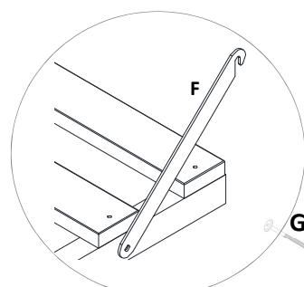
Instalar soporte somier (F) con el "gancho" hacia el extremo superior del soporte y mirando hacia abajo
